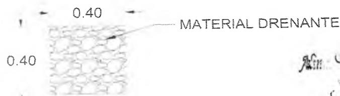
Figura 11: Material de enchimento de dreno subsuperficial
