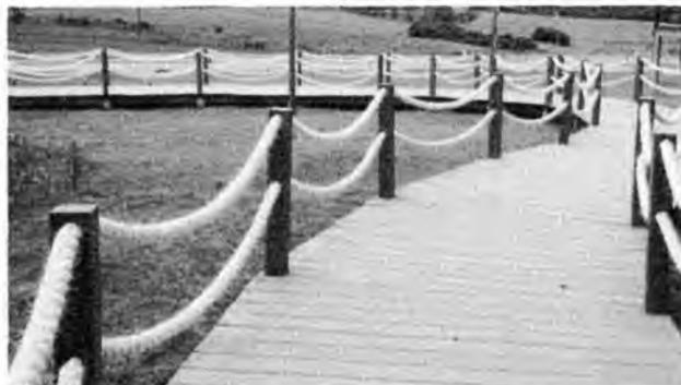
Figura 13: Guarda-corpo de madeira e sisal a ser instalado no Ponto de Apoio e Miniparque
