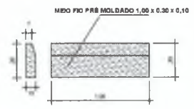
DET. MEIO FIO SEM ESC.
