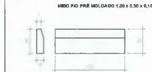
DET. MEIO FIO SEM ESCALA
