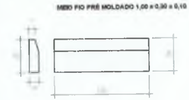
DET. MEIO FIO SEM ESCALA
