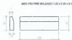
DET. MEIO FIO SEM ESC.
