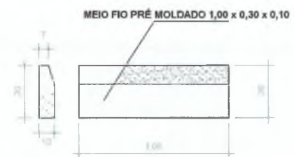
DET. MEIO FIO SEM ESCALA
