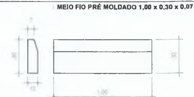
DET. MEIO FIO SEM ESC.
