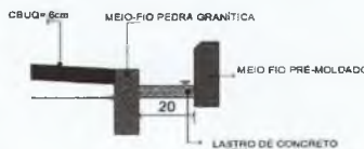
DETALHE CANALETA SEM ESC.
