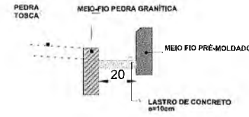
DETALHE CANALETA SEM ESC.
