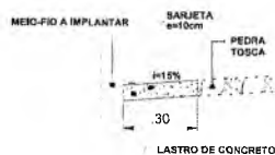
DETALHE DA SARJETA SEM ESCALA
