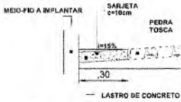
DETALHE DA SARJETA SEM ESCALA
