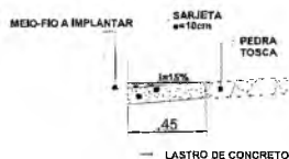
DETALHE SARJETA SEM ESC.
