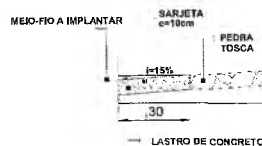
DETALHE SARJETAS SEM ESC.
