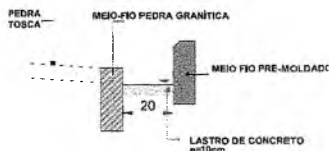
DETALHE CANALETA SEM ESC.
