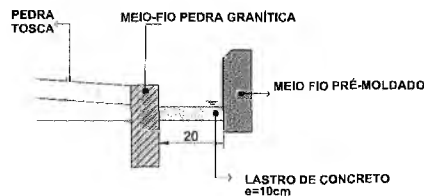
DETALHE CANALETA SEM ESC.
