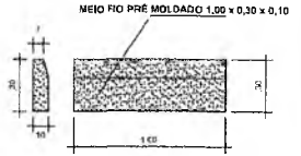
DETALHE MEIO FIO SEM ESCALA
