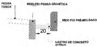
DETALHE CANALETA SEM ESC.
