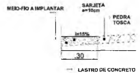
DETALHE SARJETA SEM ESC.
