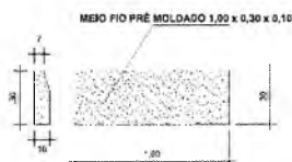
DET. MEIO FIO SEM ESC.
