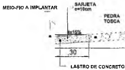
DETALHE SARJETA SEM ESC.
