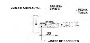
DETALHE SARJETA SEM ESC.
