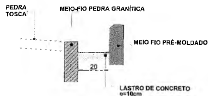
DETALHE CANALETA SEM ESC.
