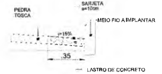
DETALHE SARJETA SEM ESCALA
