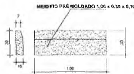
DET. MEIO FIO SEM ESC.
