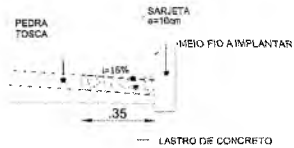
DETALHE SARJETA SEM ESCALA
