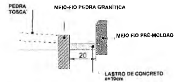
DETALHE CANALETA SEM ESC.
