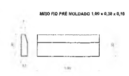
DETALHE MEIO FIO SEM ESCALA
