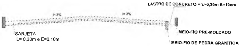
PERFIL TRANSVERSAL SEM ESC.
