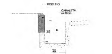
DET. CANALETA DE CONCRETO - CAU 04 SEM ESC.
