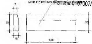
DETALHE MEIO FIO SEM ESCALA
