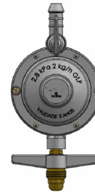
DETALHE VÁLVULA DE GÁS
