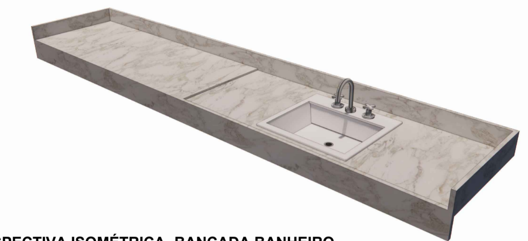
PERSPECTIVA ISOMÉTRICA - BANCADA BANHEIRO FAMILIAR ESCALA: S/E
