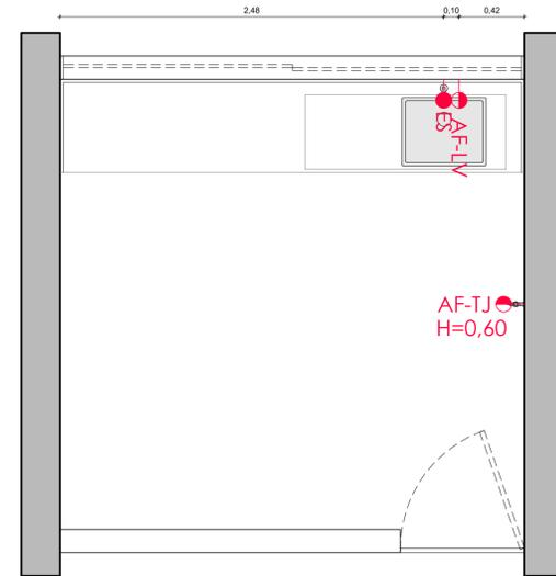
**PLANTA DE PONTOS HIDRÁULICOS**
