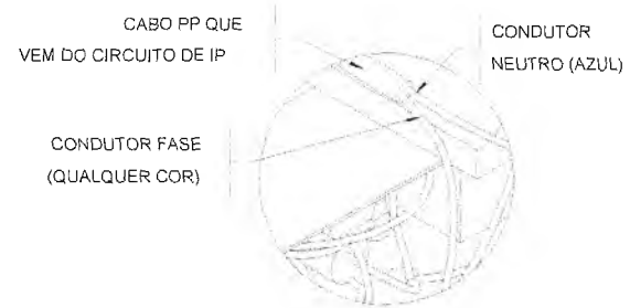
DETALHE 3 CONEXÃO DOS CONDUTORES NO CABO PP
