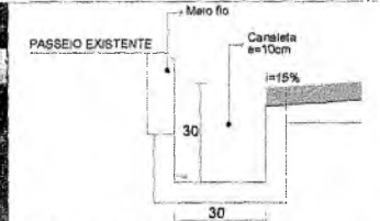
DETALHE CANALETA SEM ESC.
