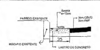
DETALHE SARJETA SEM ESC.
