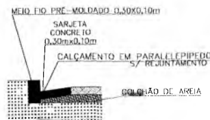
DETALHE DA SARJETA SEM ESCALA
