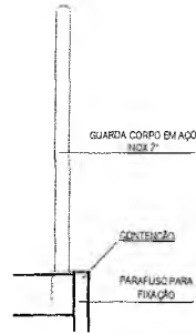
DET. GUARDA CORPO ESC. 1/25
