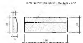
DET. MEIO FIO SEM ESCALA
