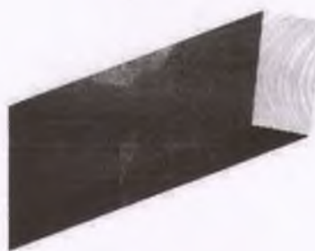
Figura 2: Reforço de viga com chapa de aço na base.
