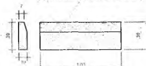
DET. MEIO FIO SEM ESCALA
