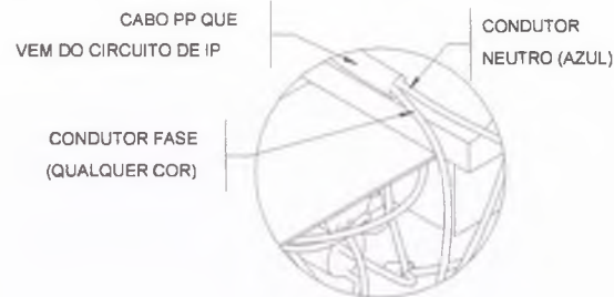
DETALHE 3 CONEXÃO DOS CONDUTORES NO CABO PP
