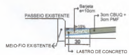
DETALHE SARJETA SEM ESC.
