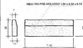
DET. MEIO FIO SEM ESCALA
