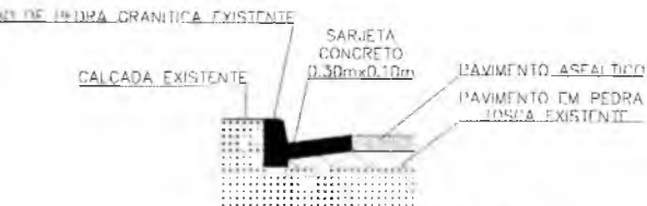
DETALHE DA SARJETA SEM ESCALA
