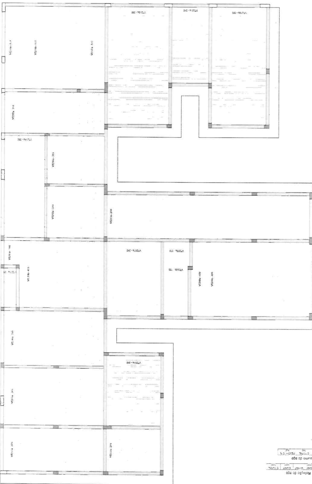
Planta de vigotas pré-moldadas
