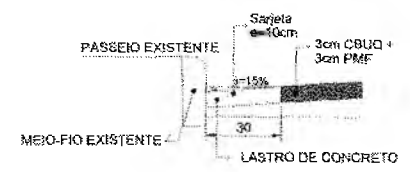
DETALHE SARJETA SEM ESC.
