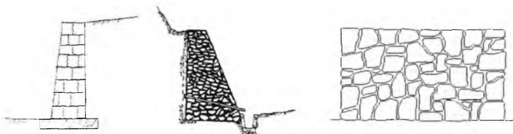
Figura 2 Muros de alvenaria de pedra
